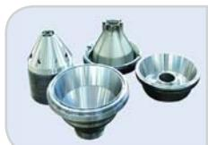
● Все ключевые детали барабана обрабатываются станками с ЧПУ, и после точной сборки каждой детали проводится проверка динамического баланса.. Барабан изготовлен из высокопрочного, коррозионно-стойкого материала из нержавеющей стали с помощью встроенной ковки под высоким давлением.
